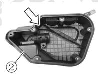
4. 清理空气滤清器壳体和空气滤清器盖②内的灰尘。
