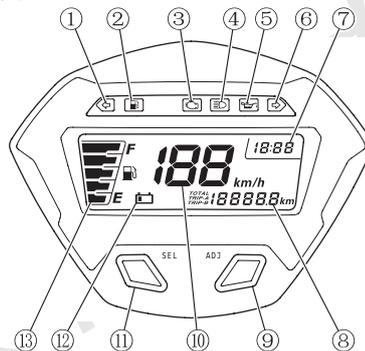
点火开关由“ $\otimes$ ”转为“ $\circ$ ”位置时, 仪表先进行开机自检: 低油位警示灯②和机油更换提示灯④点亮一次。液晶屏幕上所有可显示的内容进行扫屏。以上完成后仪表恢复正常指示。
