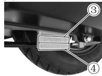
车辆识别代号(VIN)、发动机型号和发动机出厂编号是为登记摩托车时使用的。当订购配件或委托特殊服务时，该编号能使经销维修单位为您提供更好的服务。
