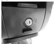
4. 把钥匙转动到“LOCK(锁)”位置，将尾箱固定在后货架上。
