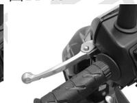
使用后制动锁定装置可以防止摩托车在停车或者怠速时移动。使用后制动锁定装置时, 先握紧后制动手柄, 然后按下按钮, 接着释放后制动手柄, 待按钮锁定不自行弹起, 表示后制动器已经锁定。
