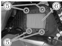
3. 拆下螺钉⑤, 拆下纸滤芯⑥, 检查纸滤芯⑥, 纸滤芯不用清理, 检查、更换纸滤芯即可。
