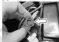
诊断接头在蓄电池的旁边。使用完毕后, 必须装回防护盖。
