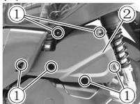
1. 拆下螺钉①, 拆下空气滤清器盖②。
