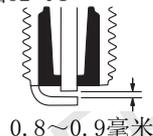
用硬铁丝或钢针把火花塞上附着的积碳清除。再用塞尺检查火花塞电极的间隙，将电极的间隙调整到0.8~0.9毫米之间。
