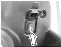
在前货箱上面, 本车配有一个5伏(5V)的电源接口。打开防护胶盖就可以看到。发动机运转时, 电源接口可以提供10瓦(10W)的电源输出。使用电器附件前, 检查额定电压和功率是否符合要求。
