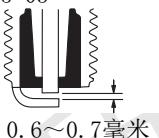
用硬铁丝或钢针把火花塞上附着的积碳清除。再用塞尺检查火花塞电极的间隙，将电极的间隙调整到0.6~0.7毫米之间。
