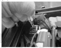
本车配有保险丝拔取器，若要取出保险丝，请使用保险丝拔取器。保险丝拔取器位于储物箱中的工具包内。
