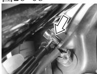
3. 断开束带③与燃油箱盖④的连接。
