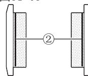
检查制动盘的要领是：看该制动盘的厚度①是否小于3.5毫米。如果厚度小于3.5毫米，就应换新制动盘。
