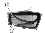
5. 清理空气滤清器盖、空气滤清器壳体内部和进、出气管内的灰尘。
