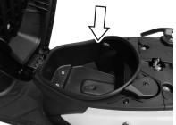
储物箱位于座垫的正下方。开启座垫锁，翻开座垫，便可看到储物箱。要锁住座垫时，推压座垫至锁定位置。储物箱载重能力为10公斤。
