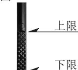
按照下列步骤检查发动机机油的油位。
