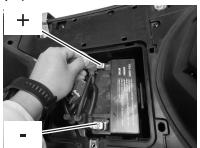
蓄电池位于脚踏下，此电池是全密封型蓄电池，因此无需补充电解液。如果拆装蓄电池，应按以下程序操作：
