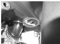
1. 拆下左右侧的螺钉①, 松开卡扣。
