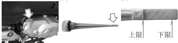
按照下列步骤检查发动机机油的油位。
