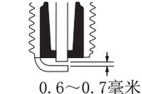
用硬铁丝或钢针把火花塞上附着的积碳清除。再用塞尺检查火花塞电极的间隙，将电极的间隙调整到0.6~0.7毫米之间。
