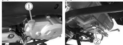
更换新的发动机机油应在发动机热机后进行。这样才容易把机内旧油全部放出。换油步骤如下：
