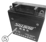
蓄电池位于右侧盖后面, 此电池是全密封型蓄电池, 因此无需补充电解液。如果拆装蓄电池, 应按以下程序操作:
