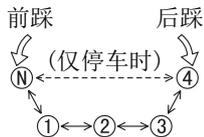
换挡杆的操作如图所示。选用一个挡位后, 换挡杆可以自行回复到原来的位置, 以便再换下一挡。
