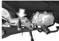
该车型在发动机的右侧装有脚起动机。
