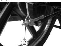
后制动踏板的自由行程①是指从踏板自由位置到踩下踏板使后轮开始制动时的踏板行程。
