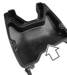
空气滤清器位于前轮挡泥板的后面。如果空气滤清器被尘土堵塞, 则进气阻力增大而输出功率减低, 同时耗油量也会增加。应按照“定期维护保养表”中的周期保养空气滤清器或更换滤芯, 步骤如下:
