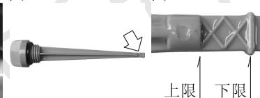
按照下列步骤检查发动机机油的油位。
