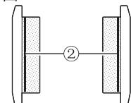
检查制动盘的要领是：看该制动盘的厚度①是否小于3毫米。如果厚度小于3毫米，就应换新制动盘。
