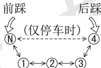
变挡杆的操作如图所示。选用一个挡位后，变挡杆可以自行回复到原来的位置，以便再换下一挡。
