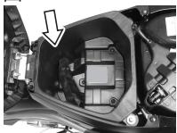
储物箱位于座垫的正下方。开启座垫锁，翻开座垫，便可看到储物箱。要锁住座垫时，推压座垫至锁定位置。储物箱载重能力为5公斤。
