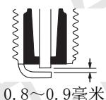
用硬铁丝或钢针把火花塞上附着的积碳清除。再用塞尺检查火花塞电极的间隙，将电极的间隙调整到 $0.8\sim0.9$ 毫米之间。
