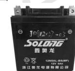
蓄电池位于座垫下的储物箱下面，此电池是全密封型蓄电池，因此无需补充电解液。如果拆装蓄电池，应按以下程序操作：
