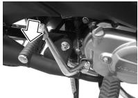
该车型在发动机的右侧装有脚起动杆。
