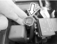
诊断接头在蓄电池的旁边。使用完毕后，必须装回防护盖。
