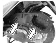
空气滤清器位于后轮的左侧。如果空气滤清器被尘土堵塞，则进气阻力增大而输出功率减低，同时耗油量也会增加。应按照“定期维护保养表”中的周期保养空气滤清器或更换滤芯，步骤如下：
