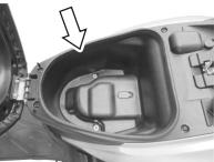
储物箱位于座垫的正下方。开启座垫锁，翻开座垫，便可看到储物箱。要锁住座垫时，推压座垫至锁定位置。储物箱载重能力为10公斤。
