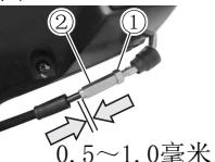
油门拉索间隙的调整部件位于油门控制手把的侧下方，如果需要调整油门拉索间隙，请按如下方法调整。
