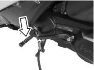
本摩托车装有脚起动杆，位于发动机的左边。要起动发动机时，需用主停车架平稳地支起摩托车后，再用力踩下脚起动杆。
