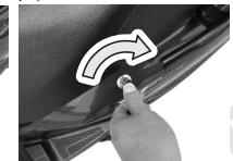
座垫锁开关位于左侧盖上。插入钥匙后，将钥匙顺时针方向旋转，即可开启座垫锁。要锁住座垫锁时，推压座垫使座垫锁舌扣在锁定的位置。
