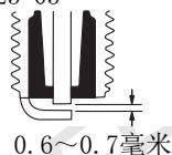
用硬铁丝或钢针把火花塞上附着的积碳清除。再用塞尺检查火花塞电极的间隙，将电极的间隙调整到0.6~0.7毫米之间。
