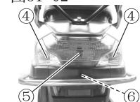
①前转向灯灯泡(左右各1个) ④后转向灯灯泡(左右各1个)
