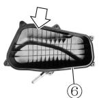
5. 清理空气滤清器盖、空气滤清器壳体内部和进、出气管内的灰尘。
