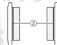
检查制动盘的要领是：看该制动盘的厚度①是否小于3.5毫米。如果厚度小于3.5毫米，就应换新制动盘。
