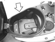
储物箱位于座垫的正下方。开启座垫锁，翻开座垫，便可看到储物箱。要锁住座垫时，推压座垫至锁定位置。储物箱载重能力为10公斤。
