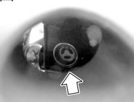
注意检查前面的制动液缸内的液面位置。如果液面过低则添加指定的制动液。因为制动片磨损时，制动液缸内的制动液会自动注入制动液软管而液面随之降低。补充制动液是定期维护保养的重要项目。
