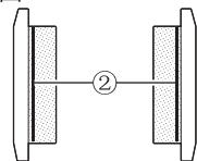
检查制动盘的要领是：看该制动盘的厚度①是否小于3.5毫米。如果厚度小于3.5毫米，就应换新制动盘。
