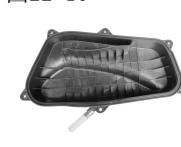
2. 拆下螺钉⑥,拆下空气滤清器盖。
