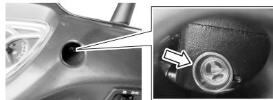
注意检查前面的制动液罐内的液面位置。如果液面过低则添加指定的制动液。因为制动片磨损时，制动液罐内的制动液会自动注入制动液软管而液面随之降低。补充制动液是定期维护保养的重要项目。
