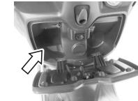
该摩托车安装有前货箱，如要打开此箱，需将钥匙插进锁内并顺时针旋转。要锁上此箱时，则推上盖子直到锁钩进入锁定的位置即可。此前货箱的载重能力为1.5公斤。
