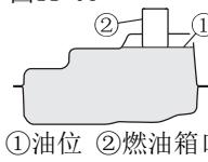
燃油箱位于座垫下方，加燃油时将座垫锁打开，翻开座垫，逆时针方向旋转燃油箱盖并取下。加完燃油后，顺时针方向拧紧燃油箱盖，将座垫下压，锁好座垫锁。
