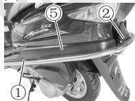
1. 拆下螺钉①,拆下膨胀扣③,拆下尾边条②,再拆下尾边条②内的螺钉④,最后拆下左后边条⑤。
